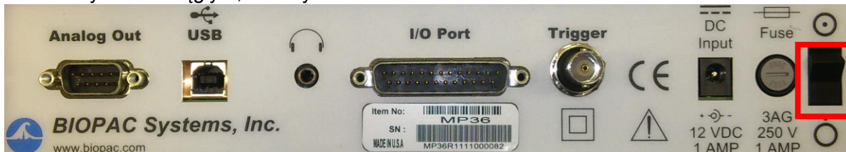
Rys. 4. Tylny panel MP36. Włącznik oznaczono czerwoną obwódką.
